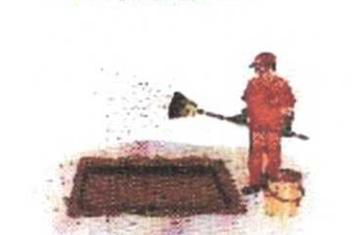
9- Preencher o local com CBUQ Faixa C, na temperatura entre 110°C e 177°C, ou PMF de graduação densa na temperatura ambiente. O preenchimento deve ser cuidadoso e ser iniciado 5 (cinco) minutos após a execução da pintura de ligação devido à necessidade da ruptura da emulsão asfáltica. Com a utilização de rastelo a massa deve ser bem espalhada preenchendo todo o espaço formado pelo recorte, nivelando a massa com o pavimento existente.
